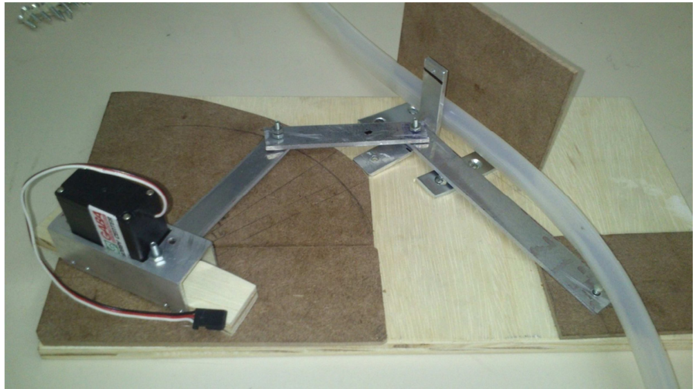
Figura 79. Primeiro Protótipo da válvula aórtica ativa – Teste de força aplicada.
