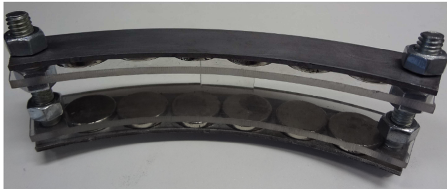
Figura 43. Atuador eletromagnético final com entreferro ajustável.
